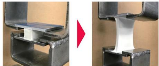
引張接着試験の様子
